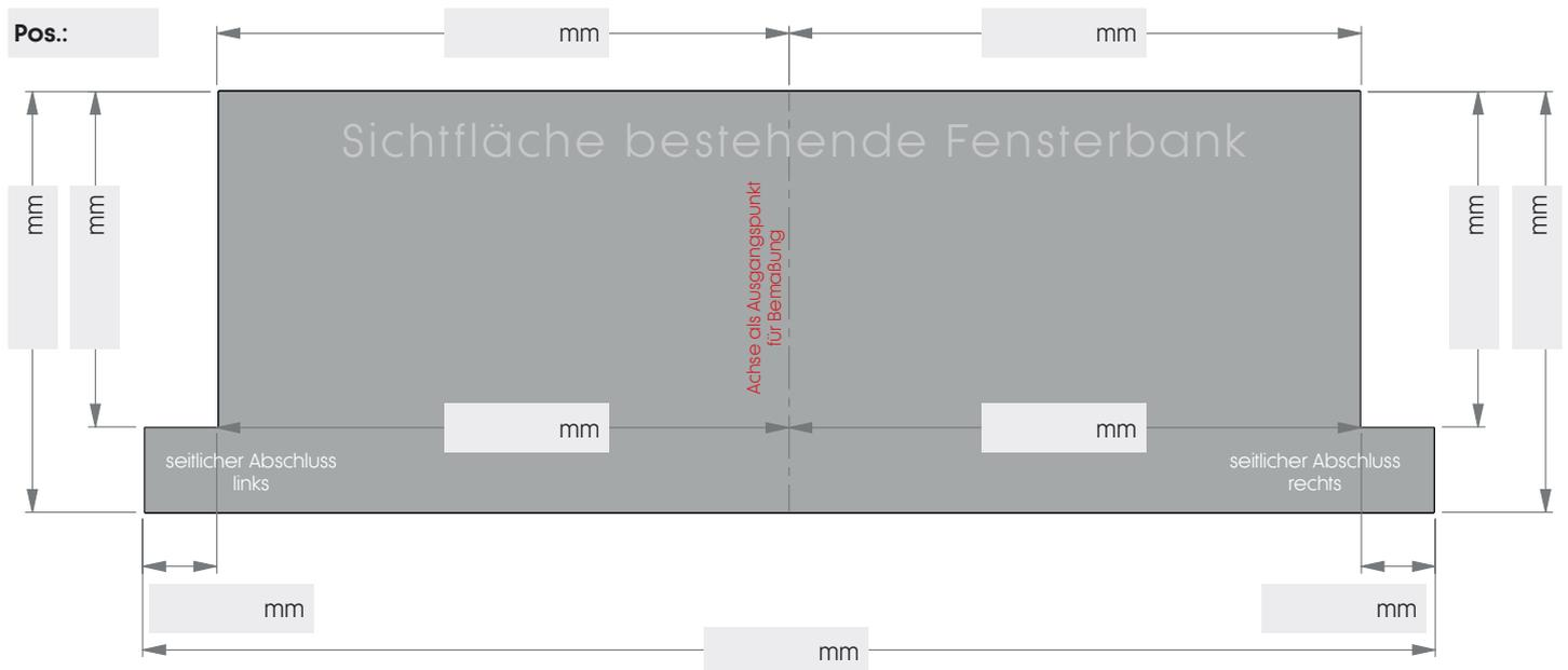
**Achtung:** Bei seitlich geschlossenem Abschluss > 60 mm ist produktionsbedingt in der Länge ein Übermaß von 20 mm je Seite erforderlich. Bei seitlich offenem Abschluss wird standardmäßig die bestehende Fensterbank um 20 mm überdeckt. Montagebedingt entstehen zwischen Sanierungsfensterbank und Fenster bzw. Wand Fugen, welche bauseits mit Acryldichtstoff zu schließen sind.
